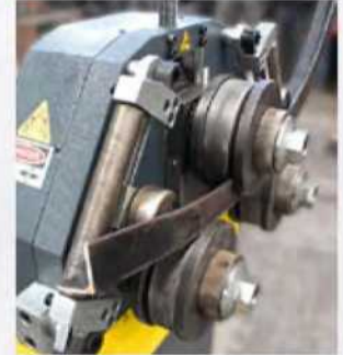
Opsiyonel Köşebent Büküm İçin Yan Dayamalar Optional Lateral Rolls for Angle Bending
