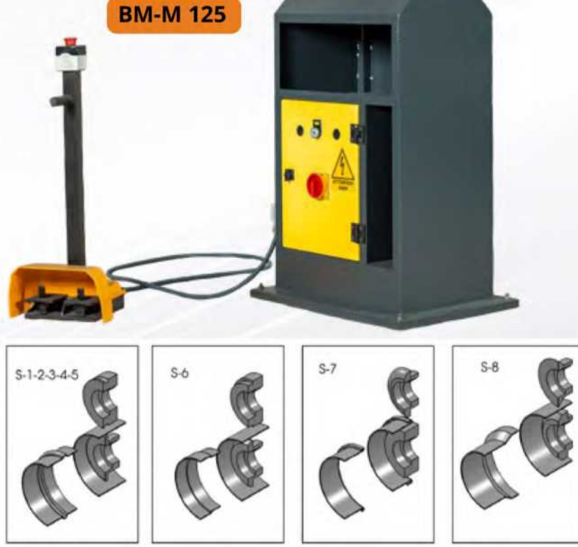
BM-M ve BM için Standart Toplar / Standard Rolls for BM-M and BM
