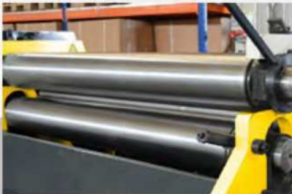
İndüksiyonlu Sert Miller Induction Hardened Rolls
